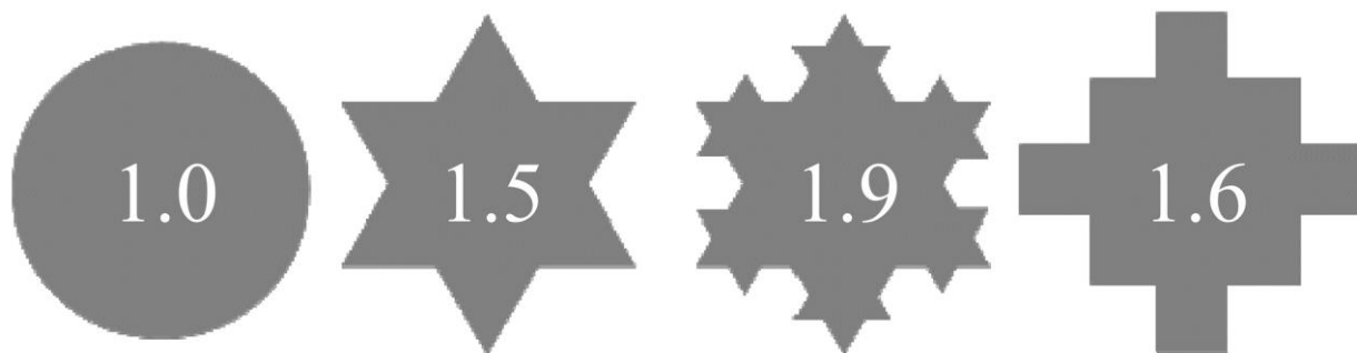
(a) 円孔 (b) 三角1次フラクタル孔 (c) 三角2次フラクタル孔 (d) 四角1次フラクタル孔
