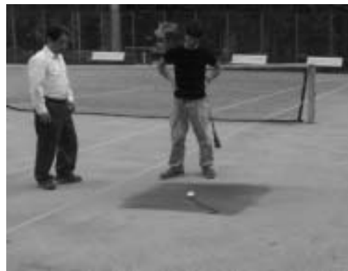
写真2 砂を除去した人工芝の放射線量測定
