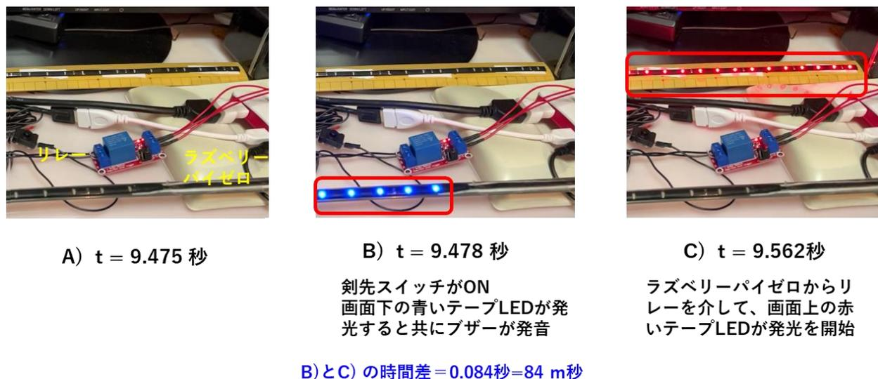
図 17 試作機による同時突き判定時間の評価
