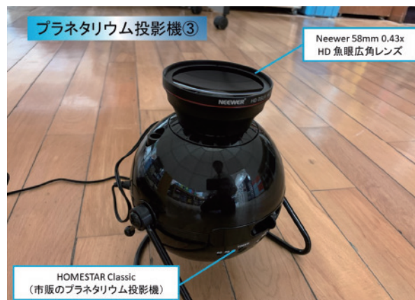
図6 市販プラネタリウム組み合わせ投影机
