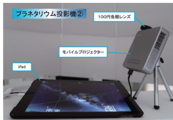
図5 簡易デジタルプラネタリウム投影机
