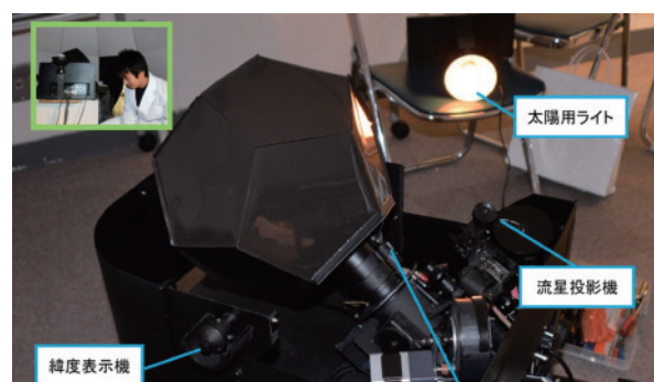
図4 ピンホール型プラネタリウム投影机
