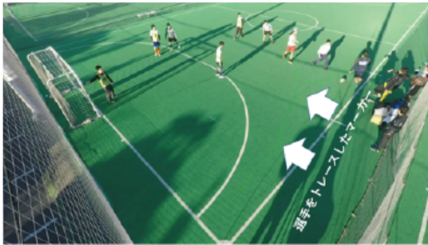
図3 広角レンズにより撮影した動画の歪みを補正し、選手の動きをトレースした画像の一例。右ライン際の選手の頭から緑色の線（マーカー）がでており、これにより選手の動きがトレースされていることが分かる。
