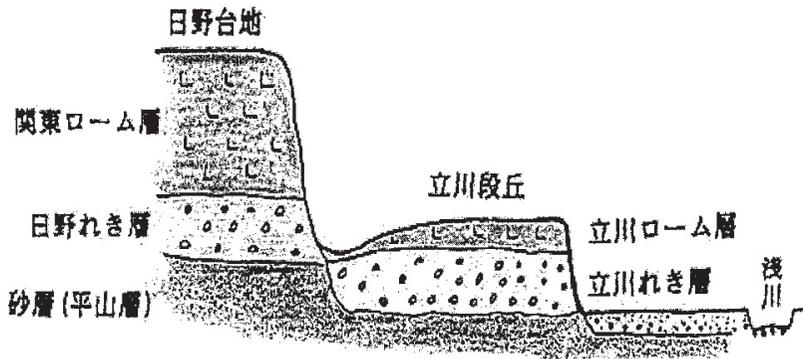
図5 日野市地下の基本構成
